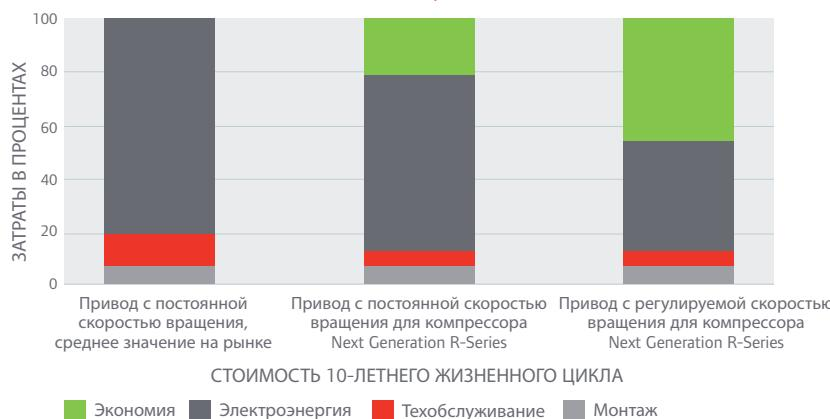
Сравнение винтовых компрессоров при средней объёмной производительности 79 %; 4000 часов в год; 0,1 евро/кВтч
