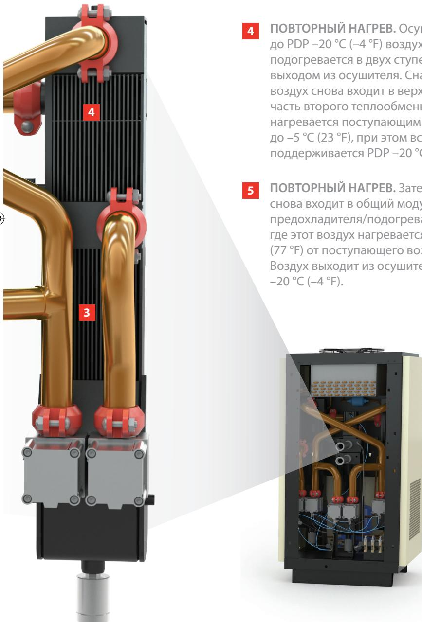
**4 ПОВТОРНЫЙ НАГРЕВ.** Осушенный до PDP  $-20^{\circ}\text{C}$  ( $-4^{\circ}\text{F}$ ) воздух повторно подогревается в двух ступенях перед выходом из осушителя. Сначала воздух снова входит в верхнюю часть второго теплообменника и нагревается поступающим воздухом до  $-5^{\circ}\text{C}$  ( $23^{\circ}\text{F}$ ), при этом всё так же поддерживается PDP  $-20^{\circ}\text{C}$  ( $-4^{\circ}\text{F}$ ).
